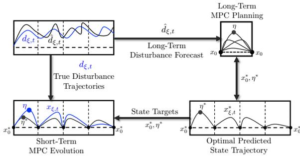
Fig. 1: Hierarchical MPC scheme.
